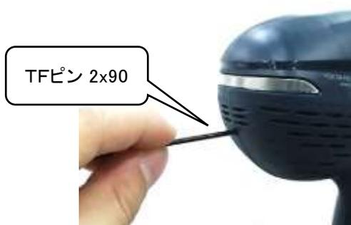
・ 押下すると同時にツール後端の白色 LED が点灯しますので、“ピッ ピッ ピーッ” とブザーが鳴るまで押し続けます。
