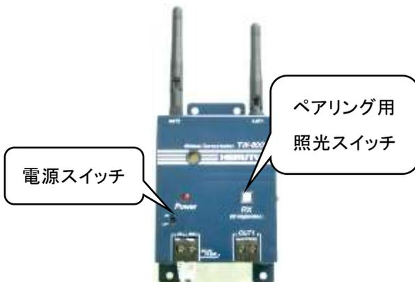
・ 10 秒間ペアリングモードとなり、ペアリング用照光スイッチが点滅し続けます。
